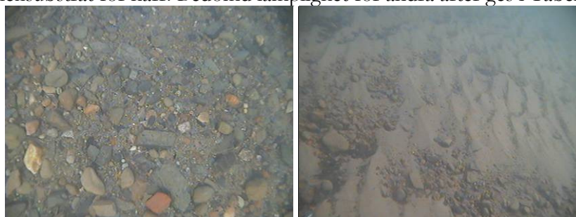
Figur 24. Bottensubstratets fraktionsstorlek var större sett till den del av yta 7 som var belägen närmast mittpi- ren. Längre ut mot hamninloppet minskade inblandningen av sådant material för att till slut helt domineras av sand.
