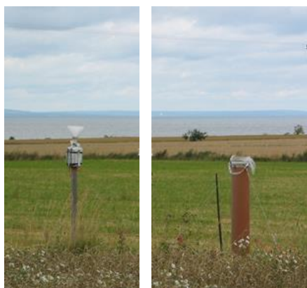
Figur 1. Bild från Visingsö 26 augusti 2009. Den tidigare provtagningsutrustningen för försurande ämnen visas längst till vänster och den nya WoF-provtagaren längst till höger i bild.
