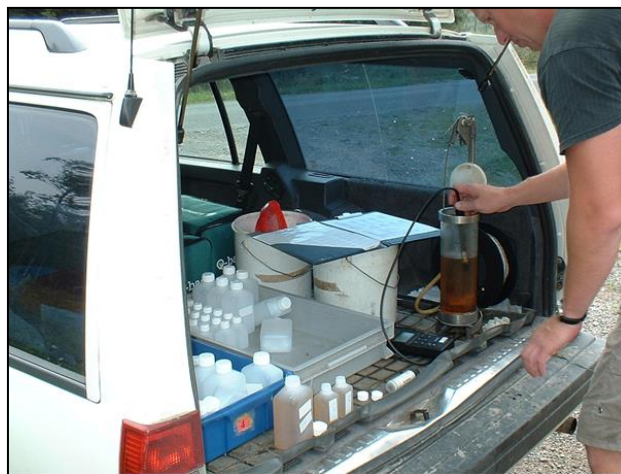
Figur 2. Mätning av syrehalt med elektrod (foto: ALcontrol AB)
