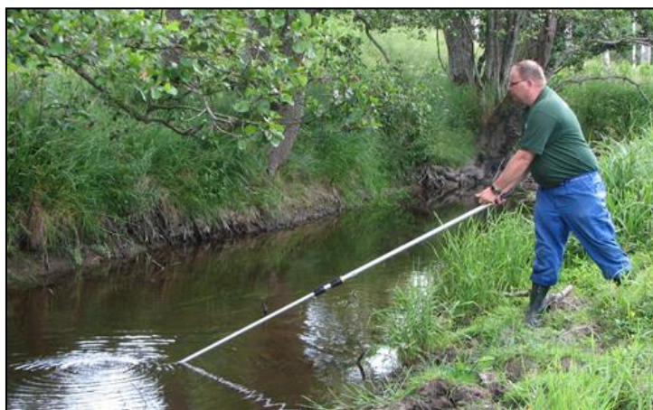
Figur 1. Vattenprovtagning med teleskophämtare (foto: ALcontrol AB)
