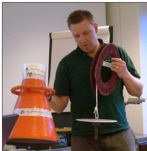
Figur 2. Siktdjup i sjöar mäts med en så kallad Secchi-skiva och vattenkikare.
