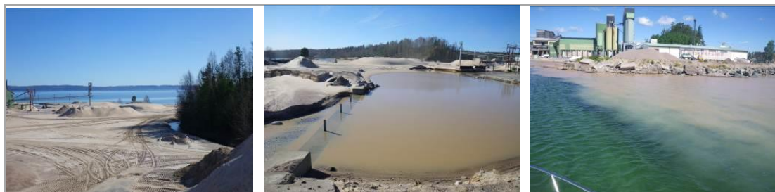
Figur 65. Sibelco Nordic AB (Baskarpsand) i Habo kommun är beläget vid Vätternkanten är en sandtäkt med utsläpp av silthaltigt vatten som medför en grumlighetsplym i Vättern. Plymen har dock bedömts inte ha betydande påverkan på Natura 2000-värden.
