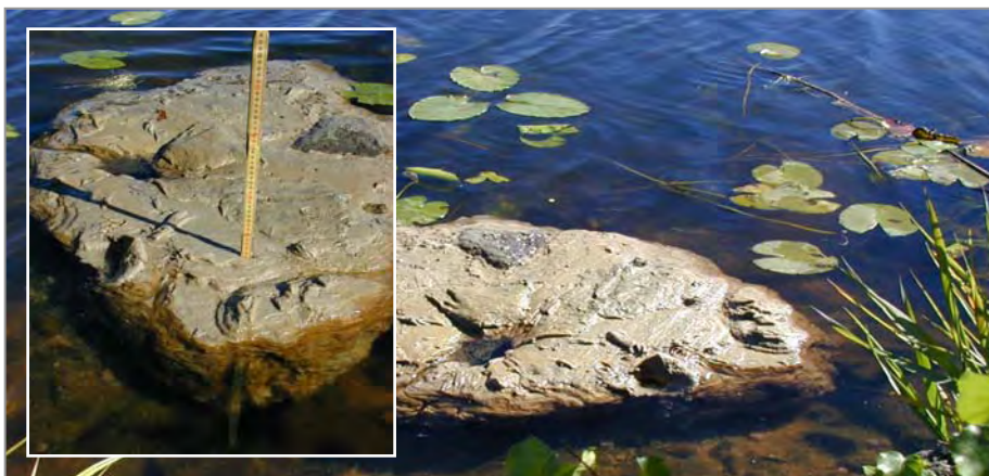
Uppflytande "kaka" från fiberbanken i Munksjön bestående av delvis nedbruten cellulosafiber täckt med ett tunt sedimentlager.
