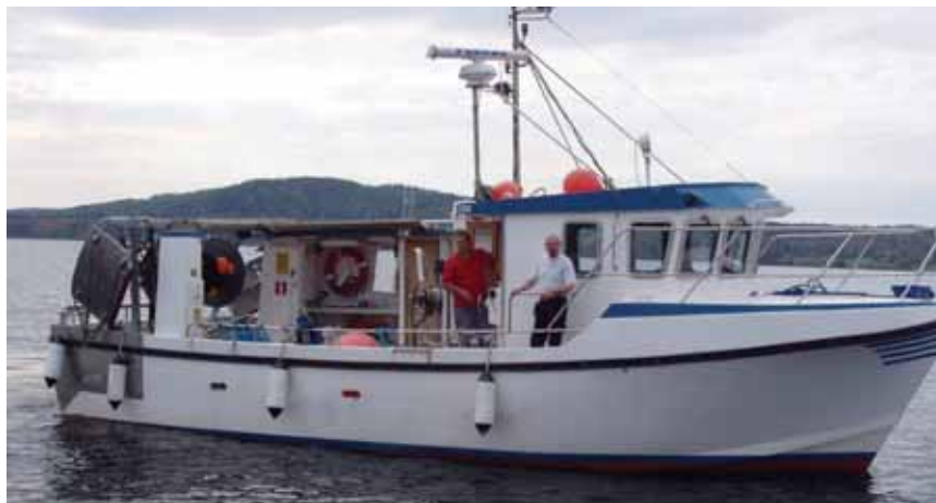
Forskningsfartyget U/F Asterix används sedan 2008 för undersökningarna i Vättern. Fartyget har hemmahamn i Mälaren vid Fiskeriverkets Sötvattenslaboratorium på Lovön, Drottningholm, och är utrustat med vetenskapligt ekolod, trål, nätdragare, vinsch mm.
