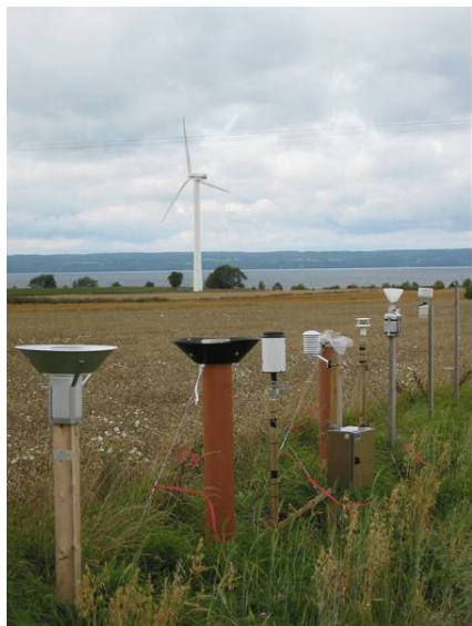
Bild från Visingsö 26 augusti 2009. Provtagningsutrustningen för försurande ämnen finns på tredje stolpen från höger i bild.
