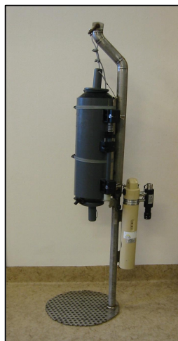
Bottenvattenhämtare med vilken Vätterns bottenvatten tas upp. På bottenvattenhämtaren sitter mätsonden monterad. Med denna sond erhålls exempelvis temperaturprofiler (se figur 7 och 8).
