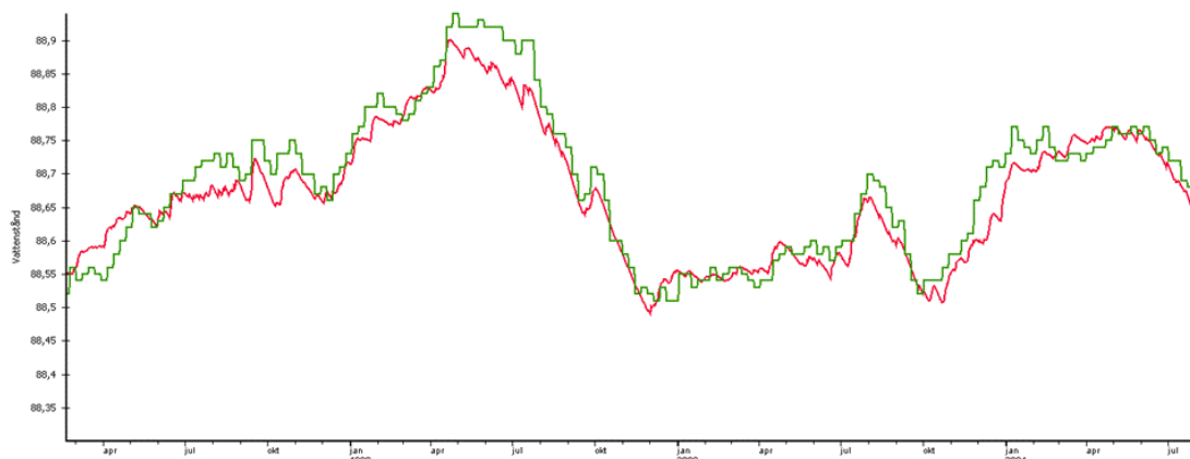
Figur 5 Exempel på resultat för HBV-modellen. Grön linje observerat naturligt vattenstånd under perioden mars 1998 till augusti 2001 och röd linje modellerat vattenstånd. Det observerade vattenståndet är visat som veckomedel, medan det beräknade är dygnsmedel.
