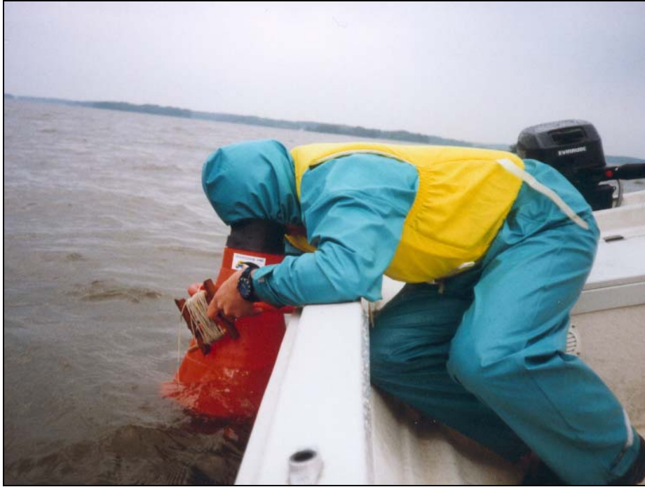
Figur 8. Mätning av siktdjup med siktskiva och vattenkikare (foto: ALcontrol AB)
