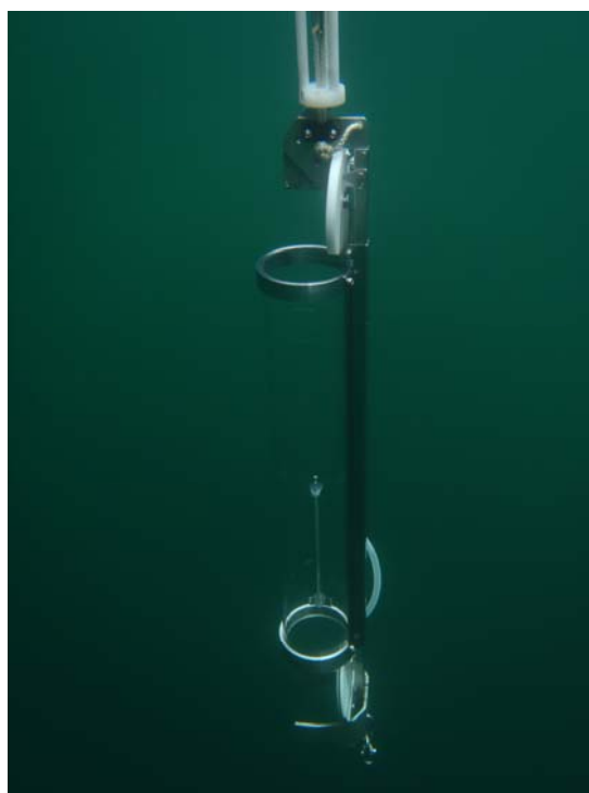
Figur 7. Limnoshämtare för vattenprovtagning i sjöar och djupare vattendrag (foto: Medins Biologi AB).
