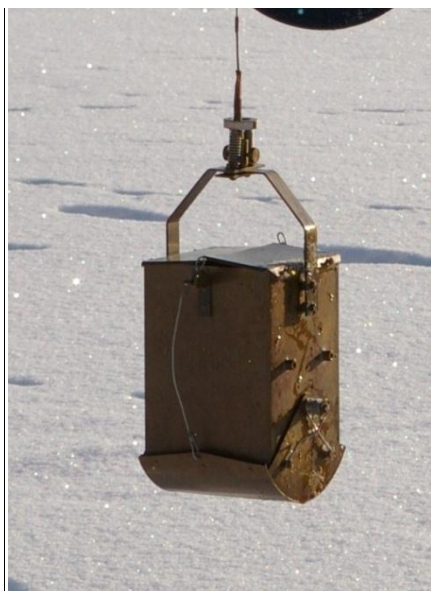
Figur 2. Ekmanhuggare har använts vid den nationella/regionala övervakningen av bottenfauna (inkl. glacialrelikta kräftdjur) i Vänern och Vättern sedan början av 1970-talet. I Vättern har dock fr o m 2004 detta redskap ersatts med van Veenhuggare.
