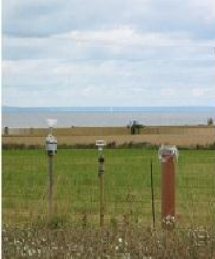
Bild från Visingsö 26 augusti 2009. Den tidigare provtagningsutrustningen för försurande ämnen är längst till vänster och den nya längst till höger i bild.
