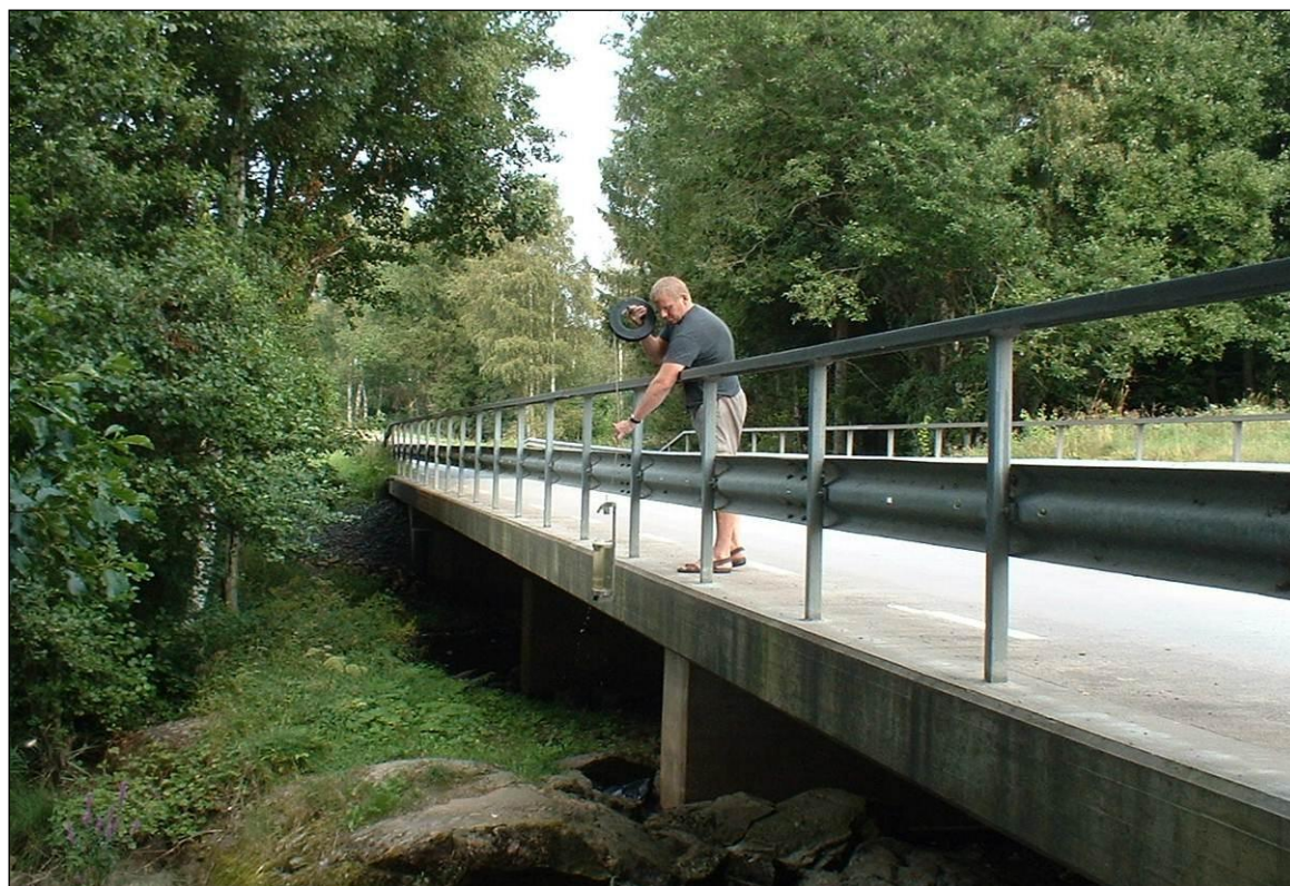
Figur 5. Provtagning med Ruttnerhämtare i ett vattendrag (foto: Ann-Charlotte Norborg Carlsson, ALcontrol).
