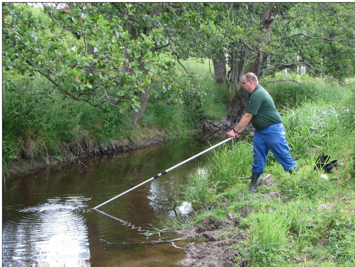
Figur 5. Vattenprovtagning med teleskophämtare vid en provplats i ett rinnande vatten (foto: ALcontrol AB)
