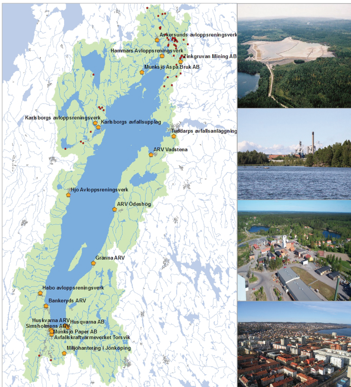
Figur 11. Punktkällornas lägen i Vätterns avrinningsområde. Vissa punktkällor leder sina utsläpp direkt till Vättern, andra till vattendrag och sjöar uppströms i Vätterns tillrinningsområde. De röda punkterna markerar gruvobjekt som ingår i länsstyrelsens EBH-databas. Dessa kan till exempel representera nedlagda gruvor eller deponier med gruvavfall. Till höger visas exempel på punktkällor som ingår i denna rapport: Zinkgruvans sandmagasin, följt av Aspa Bruk, Zinkgruvan Mining och utsikten från Munksjö AB över Jönköping.
