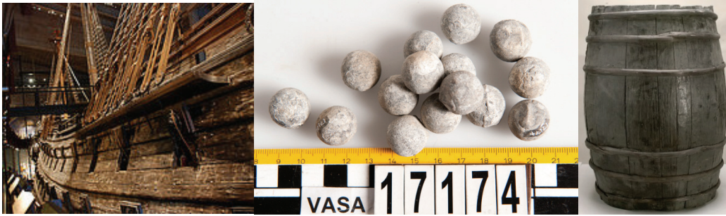
Figur 16. Muskötkulorna, som tillverkades på Regalskeppet Vasa, var 18-19 mm i diameter och vägde i genomsnitt 36,5 gram (före år 1700). Kulorna förvarades i kaggar som var placerade i hålskeppet och som därför kan förmodas ha legat relativt fritt i vattnet. Under de 333 år som kulorna legat på detta sätt i vattnet har de minskat i vikt i genomsnitt 5 gram (ca 0,04 %/år). Foton från Vasamuseets webbplats, www.vasamuseet.se .
