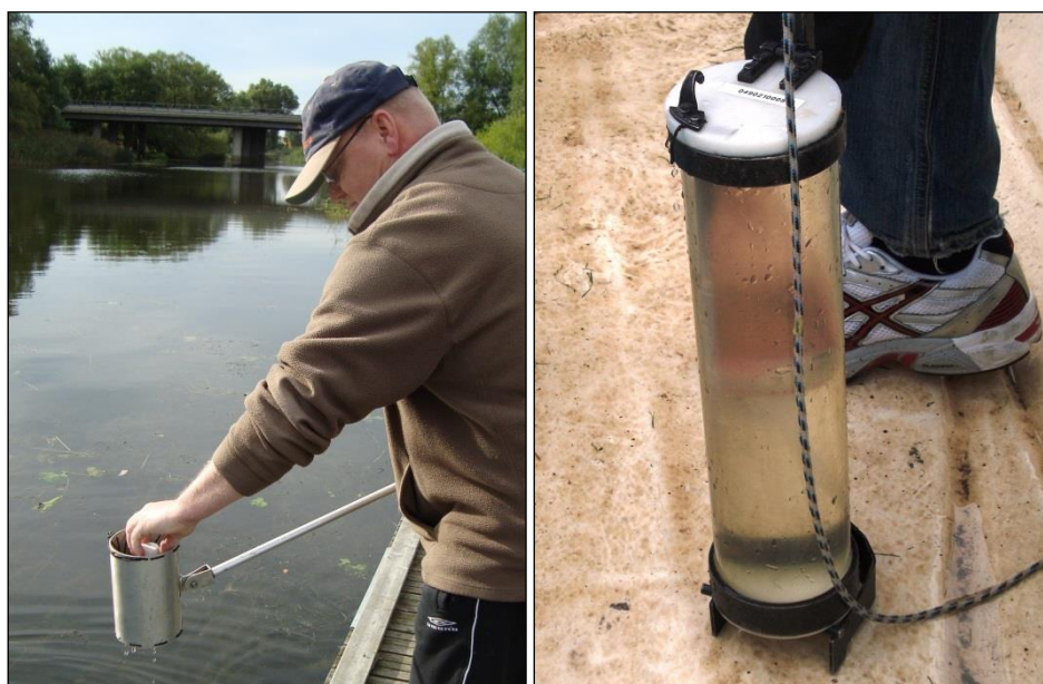
Figur 7. Fotot till vänster visar vattenprovtagning i ett rinnande vatten med en käpphämtare av modell "Spindeln", där provflaskan fästs i cylindern med hjälp av gummistroppar. Fotot till höger visar en Ruttnerhämtare för provtagning i främst sjöar och kustområden. (Foto: Ann-Charlotte Norborg Carlsson, ALcontrol AB).
