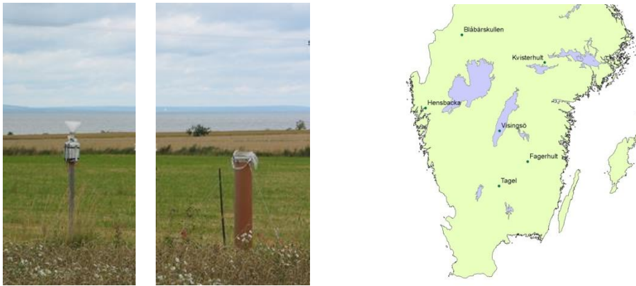
Figur 1. Bild från Visingsö 26 augusti 2009. Den tidigare provtagningsutrustningen för försurande ämnen visas längst till vänster och den nya längst till höger i bild. En karta över mätplatserna som jämförs i denna rapport: Visingsö, Blåbärskullen, Fagerhult, Hensbacka, Kvisterhult samt Tagel
