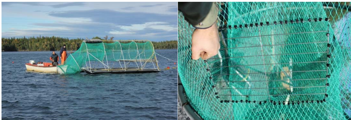
Bild 2. Push-upfällan (vänster) och selektionsgaller i fällan (höger).
