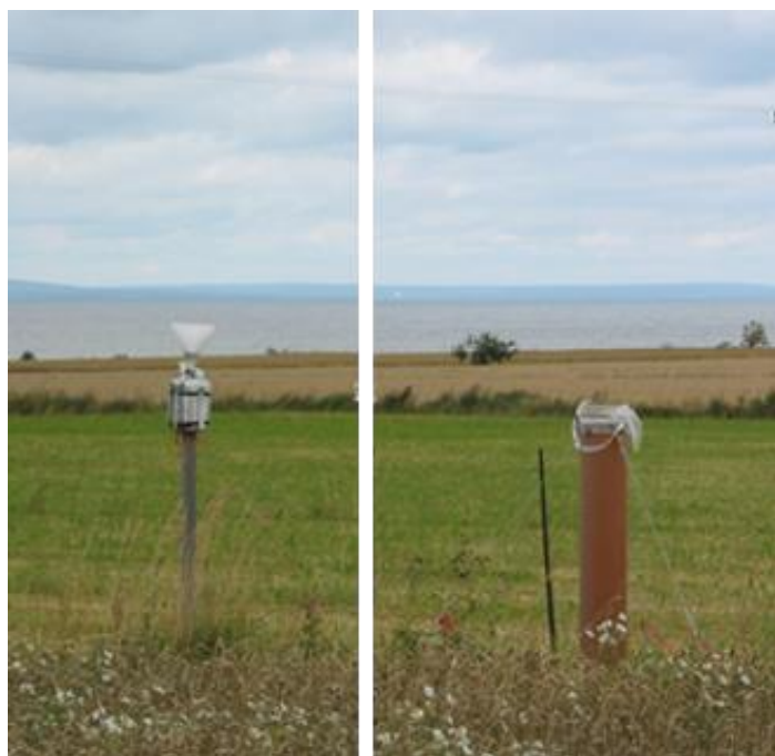
Figur 95. Bild från Visingsö 26 augusti 2009. Den tidigare provtagningsutrustningen för försurande ämnen visas längst till vänster och den nya WoF-provtagaren längst till höger i bild.
