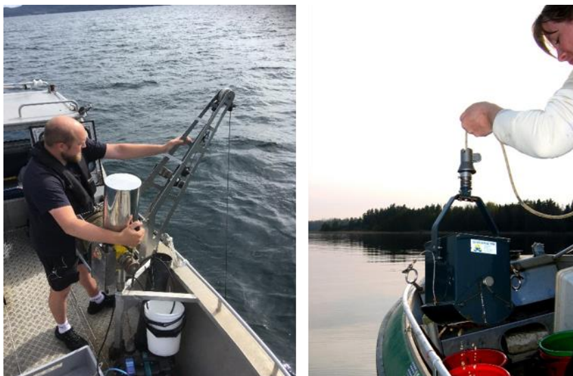
Figur 48. Provtagning av bottenfauna med van Veen-hämtare.
