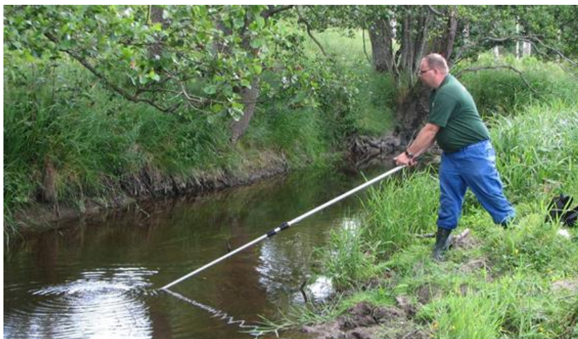
Figur 10. Vattenprovtagning med käpphämtare (foto: SYNLAB)
