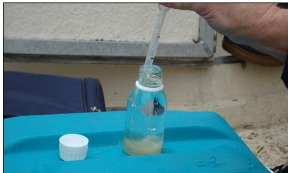
Figur 31. Provtagning av vatten för analys av syre enligt Winkler-metoden (foto: Ann-Charlotte Norborg Carlsson, SYNLAB)
