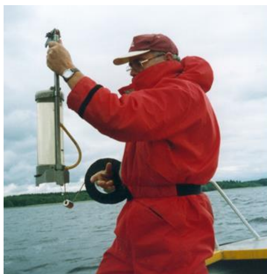
Figur 35. Vattenprovtagning med Ruttnerhämtare (foto: SYNLAB).
