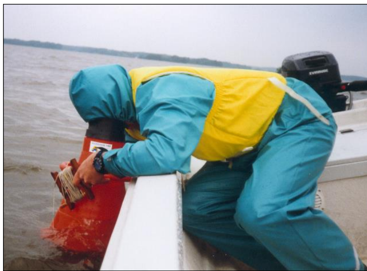
Figur 33. Mätning av siktdjup med siktskiva och vattenkikare (foto: Ann-Charlotte Norborg Carlsson, SYNLAB).
