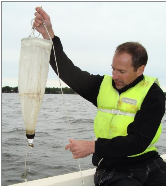
Figur 29. Håv för kvalitativ provtagning av växtplankton (foto: Ann-Charlotte Norborg Carlsson, SYNLAB).
