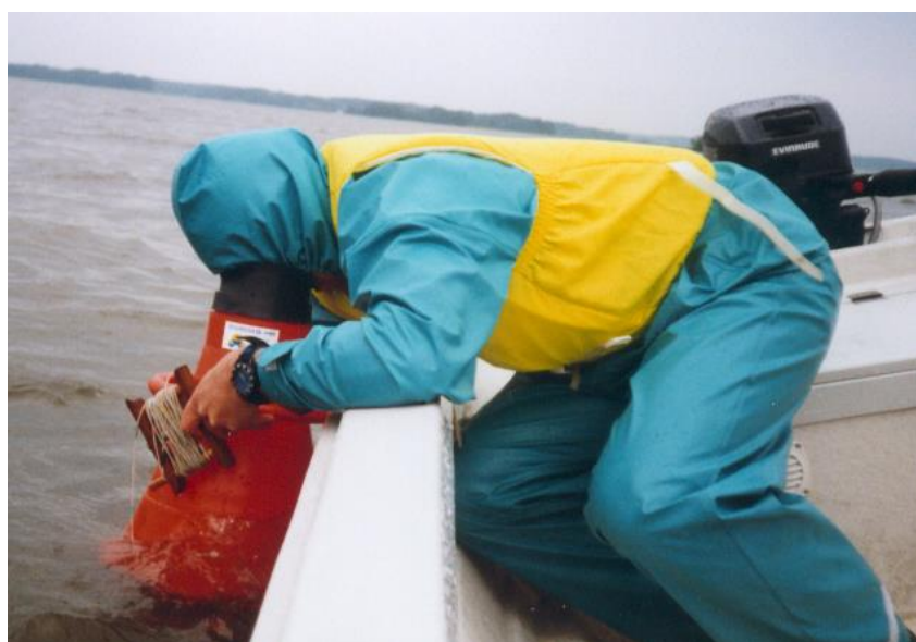
Figur 12. Mätning av siktdjup med siktskiva och vattenkikare (foto: SYNLAB).
