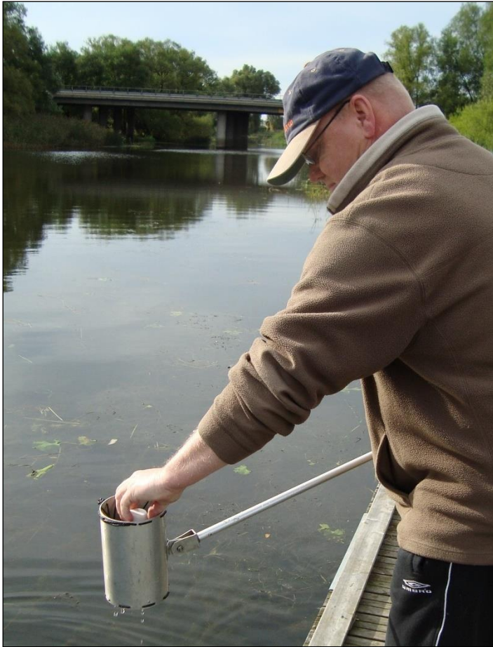
Figur 7. Vattenprovtagning med käpphämtare modell "Spindeln" där provflaskan fästs i cylindern med hjälp av gummistroppar (foto: SYNLAB).
