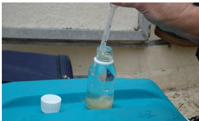
Figur 10. Provtagning av vatten för analys av syre enligt Winklermetoden (foto: SYNLAB).
