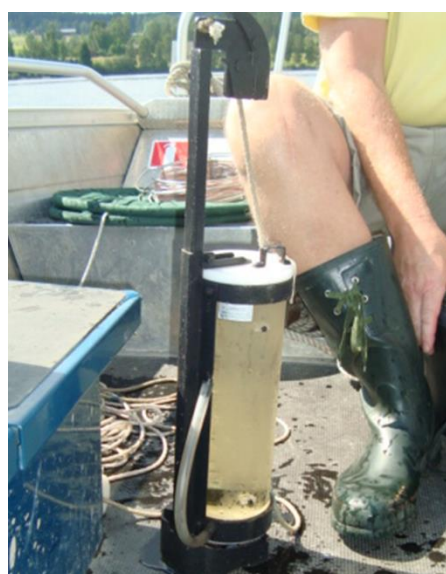
Figur 14. Vattenprovtagning med Ruttnerhämtare (foto: SYNLAB).
