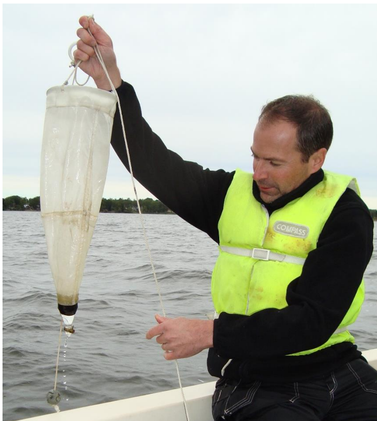
Figur 8. Håv för kvalitativ provtagning av växtplankton (foto: SYNLAB).
