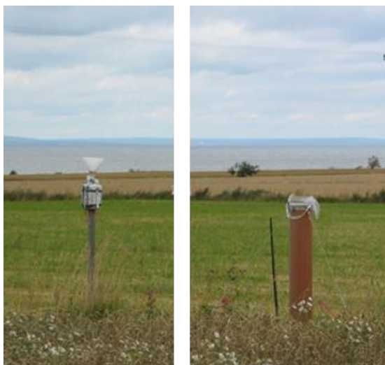
Figur 11. Bild från Visingsö 26 augusti 2009. Den tidigare provtagningsutrustningen för försurande ämnen visas längst till vänster och den nya WoF-provtagaren längst till höger i bild.
