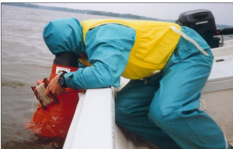
Figur 12. Mätning av siktdjup med siktiskiva och vattenkikare (foto: SGS).
