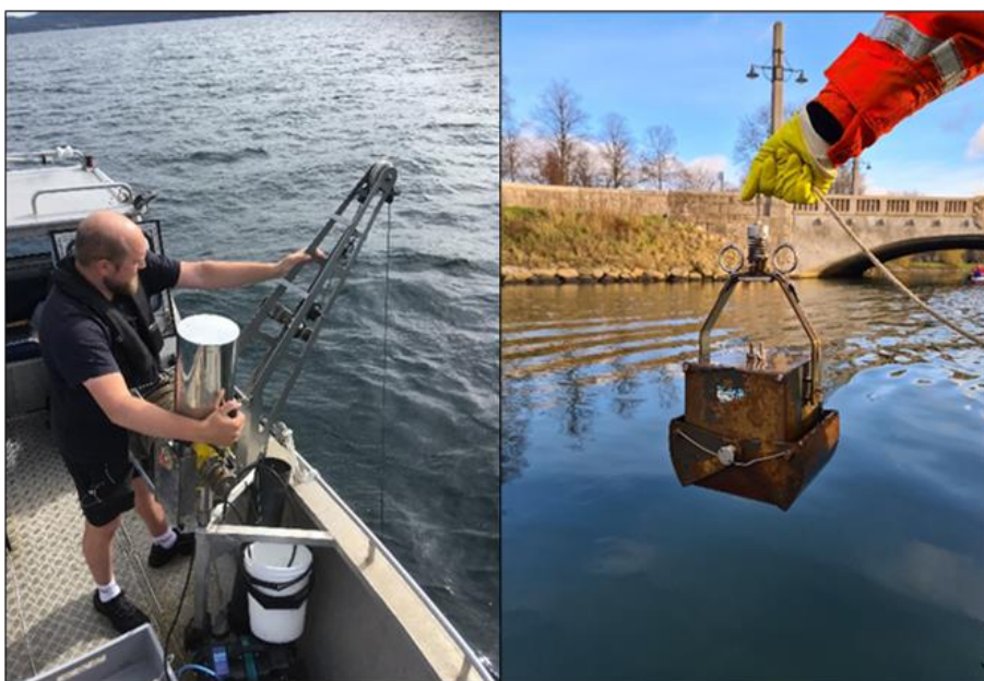
Figur 2. Provtagning av bottenfauna med van Veen-hämtare (till vänster) respektive Ekmanhäm- tare (till höger).
