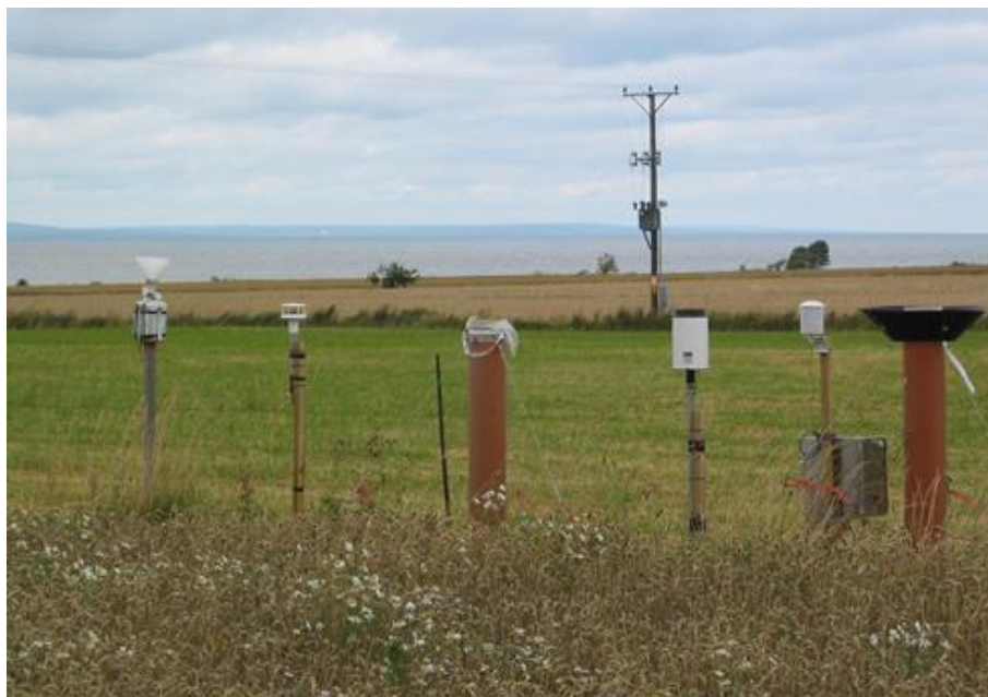
Figur 11. Bild från Visingsö 26 augusti 2009. Den tidigare provtagningsutrustningen för försurande ämnen visas längst till vänster och den då nya WoF-provtagaren som nummer tre från vänster, mitt i bild.
