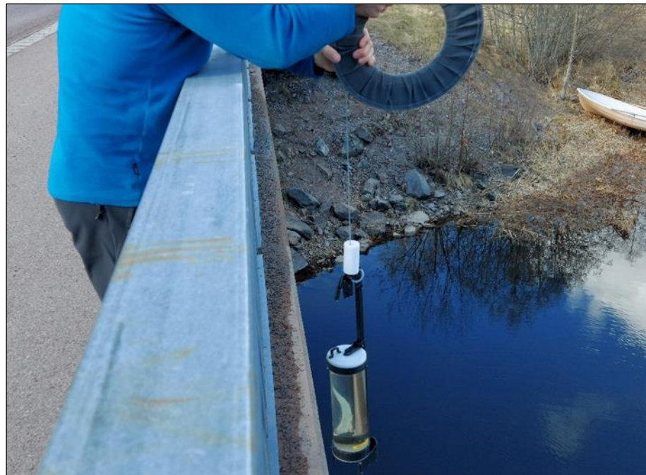
Figur 14. Vattenprovtagning med Ruttnerhämtare (foto: SGS).
