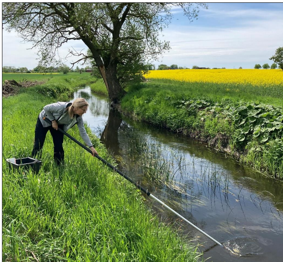
Figur 1. Vattenprovtagning med teleskophämtare (foto: SGS).
