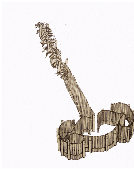
Figur 1. En gammal katsa enligt en modell från Nordiska museet. Detta är föregångaren till dagens bottengarn och laxfallor. Fisken leddes av den långa landarmen ut mot fångstgården där den inte hittade ut.
