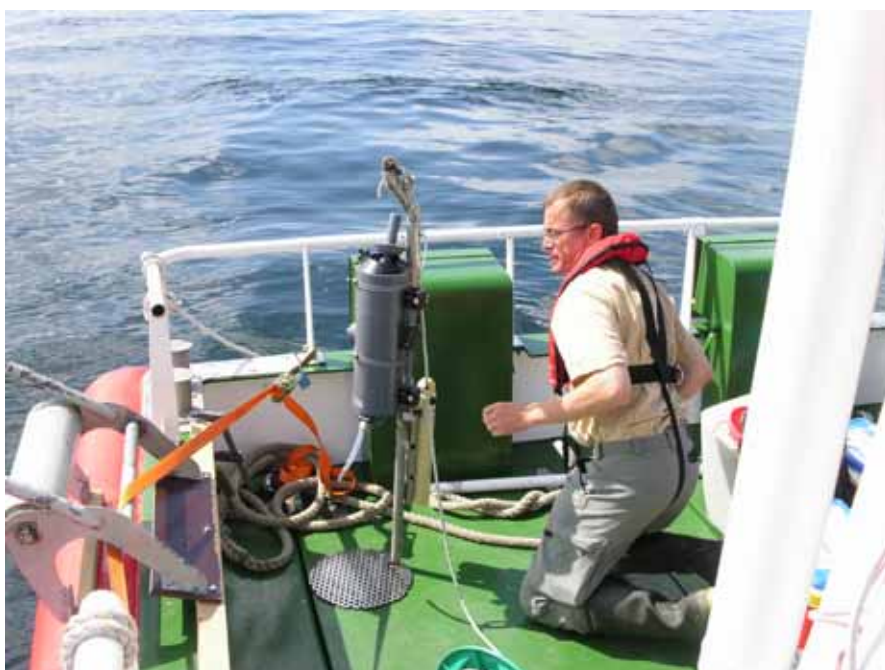
Torbjörn Johnsson, Pelagia, justerar hämtaren som ska ta upp vatten från djupen. När plattan stöter i botten stängs cylindern och vatten 1,0 m ovanför botten stängs inne och kan föras upp.
