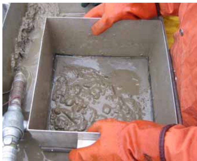
Bottendjuren skiljs från sedimentet genom sållning med ett 0,5 mm såll. Kladdigt och söligt.
