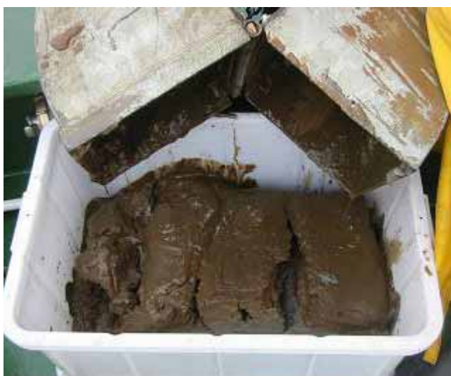
Sedimentet från Van Veen-huggaren töms ur hämtaren för att sållas.
